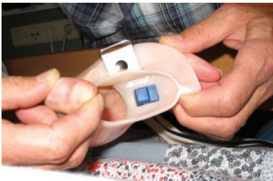
De voor Peter Jan op maat gemaakte spalk waar op precies de juiste plaats een schakelaar ingebouwd werd
